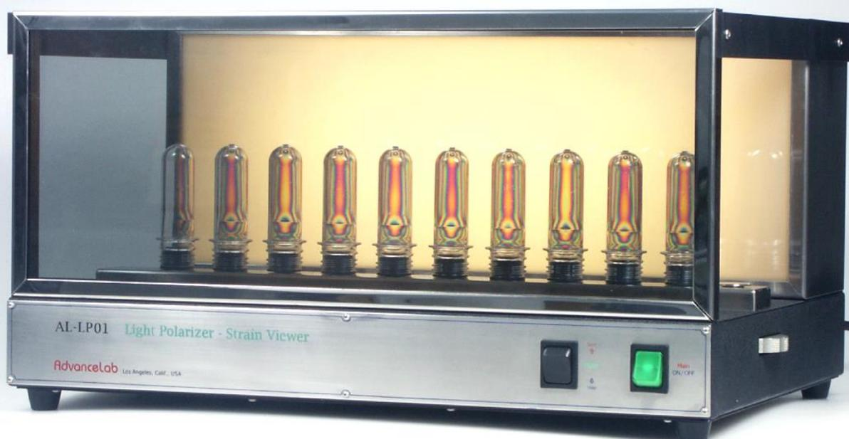
Modelo sostiene 10 preformas para botellas de 16 onzas o 600 ml. Diferentes medidas de accesorios y configuraciones pueden ser ordenados. 10 o menos accesorios en una sola inspeccion dependiendo de la medida de la preforma.
